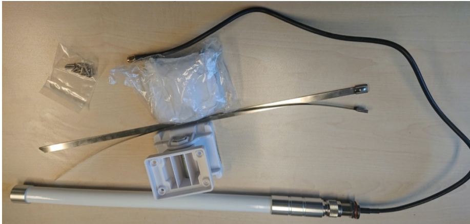
Abbildung 3: Befestigungsmaterial für das Gateway und die Gateway-Antenne
