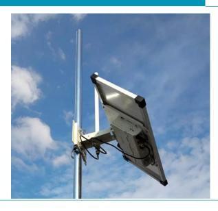
La pasarela 4G exterior recibe mensajes LoRa de los sensores FireFly y envía los datos por Internet a la base de datos. Una sola pasarela es suficiente para procesar los datos procedentes de hasta 100 FireFlies. Adecuada para su uso en exteriores, esta pasarela GoutSolar se conecta a través de una conexión 4G y/o un cable Ethernet.
