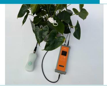
El sensor Sendot Photo Efficiency puede vincularse al FireFly. Esto permite que los datos del sensor se lean digitalmente en la plataforma deseada (incluyendo LetsGrow, Sendot y Ledgnd).
