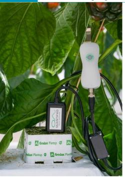
'El sensor Poseidon WET mide la permitividad, la electro-conductividad (EC) y la temperatura del suelo o sustrato. Están disponibles las versiones simple, doble y triple. Éstas permiten monitorizar el transporte de agua y nutrientes a través del suelo. El (multi-) Poseidon debe ser conectado a un FireFly.
