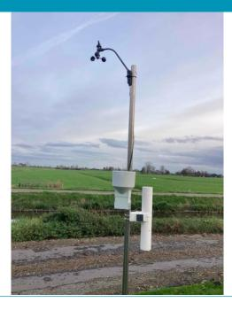
La estación meteorológica consta de anemómetro, pluviómetro, temperatura del aire y humedad relativa. Entre las características opcionales se incluyen un módulo GPS y un mástil de acero inoxidable.
