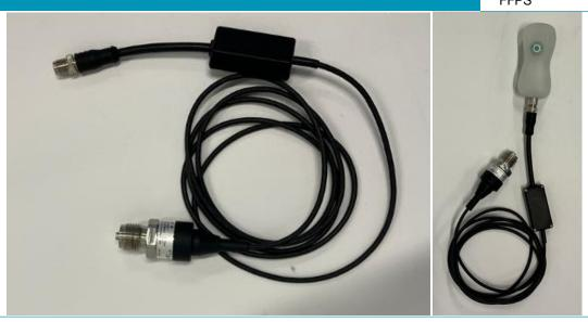
El sensor de presión de líquidos mide la presión de las tuberías en, por ejemplo, sistemas de suministro de agua y fertirrigación. El sensor de presión se monta con una rosca exterior (recta) G 1/2 pulgadas. El sensor de presión se conecta a un FireFly.
