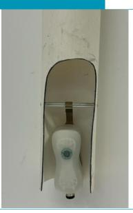
El clip permite instalar el FireFly con un gancho que cuelga verticalmente de un cable de hasta 6 mm de diámetro. Este clip se utiliza, entre otras cosas, para el montaje en la Macro Chimenea Solar
