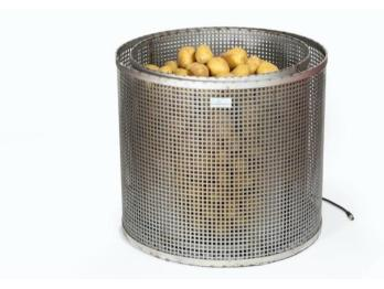
El Potato Guard mide en tiempo real la pérdida de peso de las patatas de siembra durante el almacenamiento. Esta medición le ayuda a establecer los parámetros de climatización y ventilación, minimizando la pérdida de masa y calidad durante el almacenamiento. El Potato Guard se entierra al nivel de la parte superior del almacén. Puede aplicarse una tapa opcional para mediciones más profundas.
