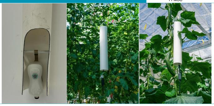
La Macro Chimenea Solar es una carcasa con ventilación pasiva para el FireFly. En entornos con alta irradiación (crecimiento directo o luz solar), esta carcasa proporciona una medición más precisa de la temperatura y la humedad relativa del aire. Cuando se utiliza la Macro Chimenea Solar, la medición PAR no es utilizable porque el sensor de luz está apantallado.
