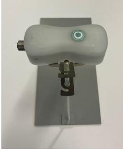
Base de plástico (15 x 10 cm) para la fijación vertical de un bastón de fibra de vidrio (6 mm de diámetro). Para utilizar en combinación con el clip FFSCang Smart. Opciones de posición del bastón: centrado en el pie o en el extremo del pie.
