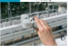
El clip se puede utilizar para montar el FireFly en un cable de 2..3.5 mm de diámetro o en un palo de 6..7 mm de diámetro.
