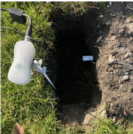
Plaats de firefly en werk de kabels zoveel mogelijk onder de grond
